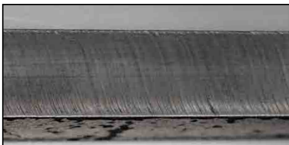
Coupe de qualité jusqu'à 12 mm et séparation jusqu'à 20 mm Corte de calidad hasta 12 mm y separación hasta 20 mm
