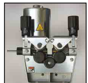
4 rulli ingranati D.30mm 4 geared rolls D.30mm
