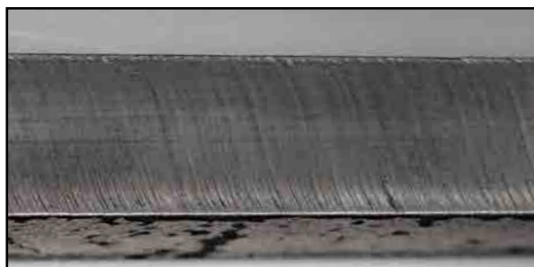
Taglio di qualità fino a 12mm e separazione fino a 20mm Quality cut up to 12mm and severance up to 20mm
