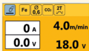
Cruscotto saldatura MIG manuale Manual MIG welding dashboard
